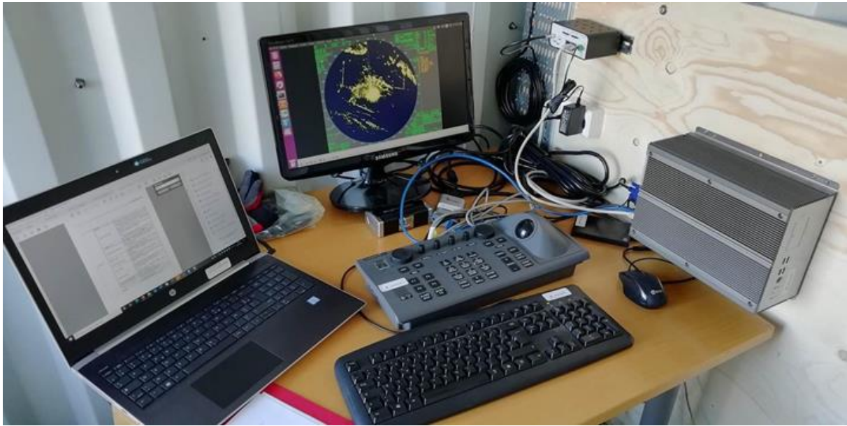
MYND 5.4 Tækjabúnaður sem notaður er til þess að stjórna ratsjá og safna gögnum.
