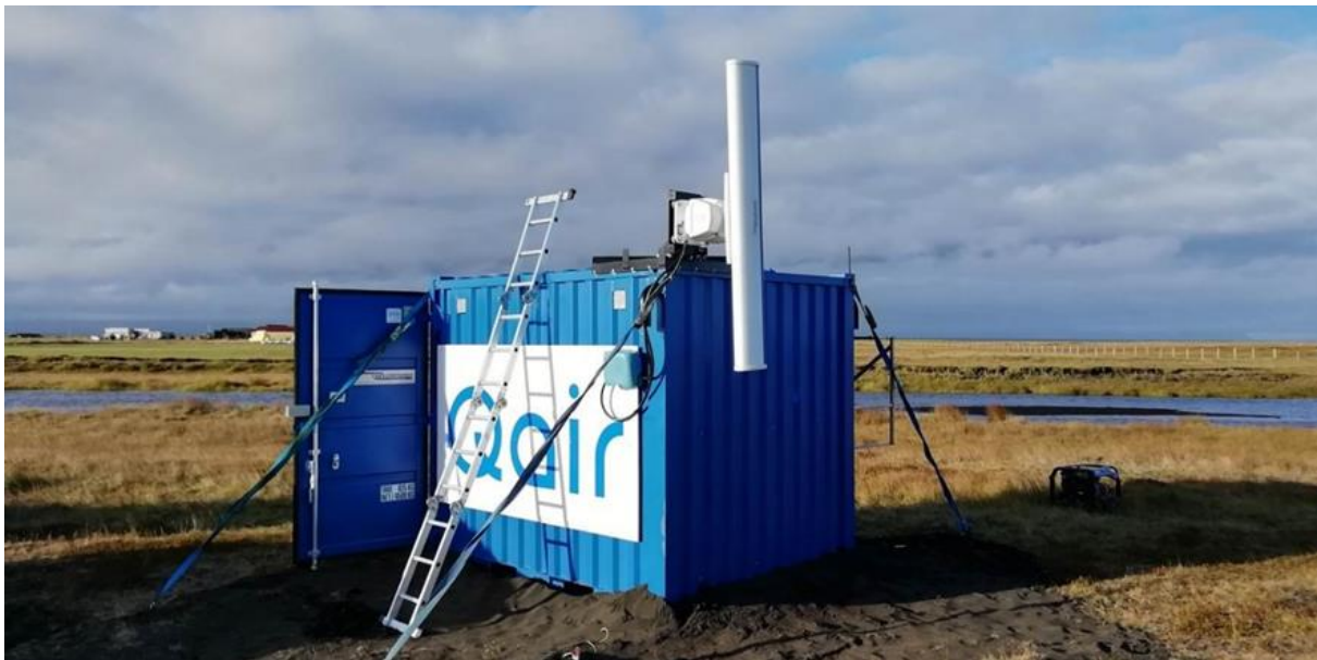
MYND 5.7 Uppsetning ratsjár fyrir lóðréttu stillingu.
